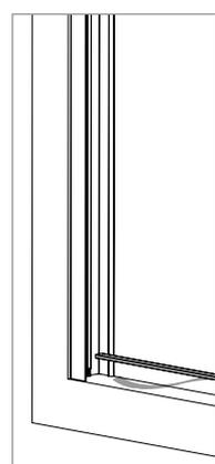
**10** Rimuovere la pellicola protettiva del biadesivo dalla guida inferiore, applicare a pavimento la guida tra i due profili laterali.
