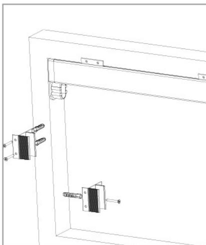
**4** Fissare i fermo guida SX e DX utilizzando il foro centrale o i fori laterali.
