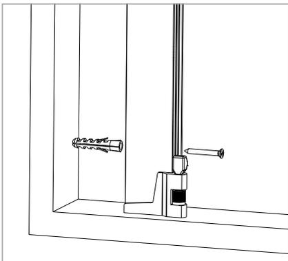
**7** Procedere con il fissaggio delle guide laterali.
