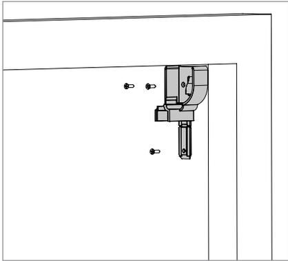
**1** Fissare una delle due copritestate al vano.
